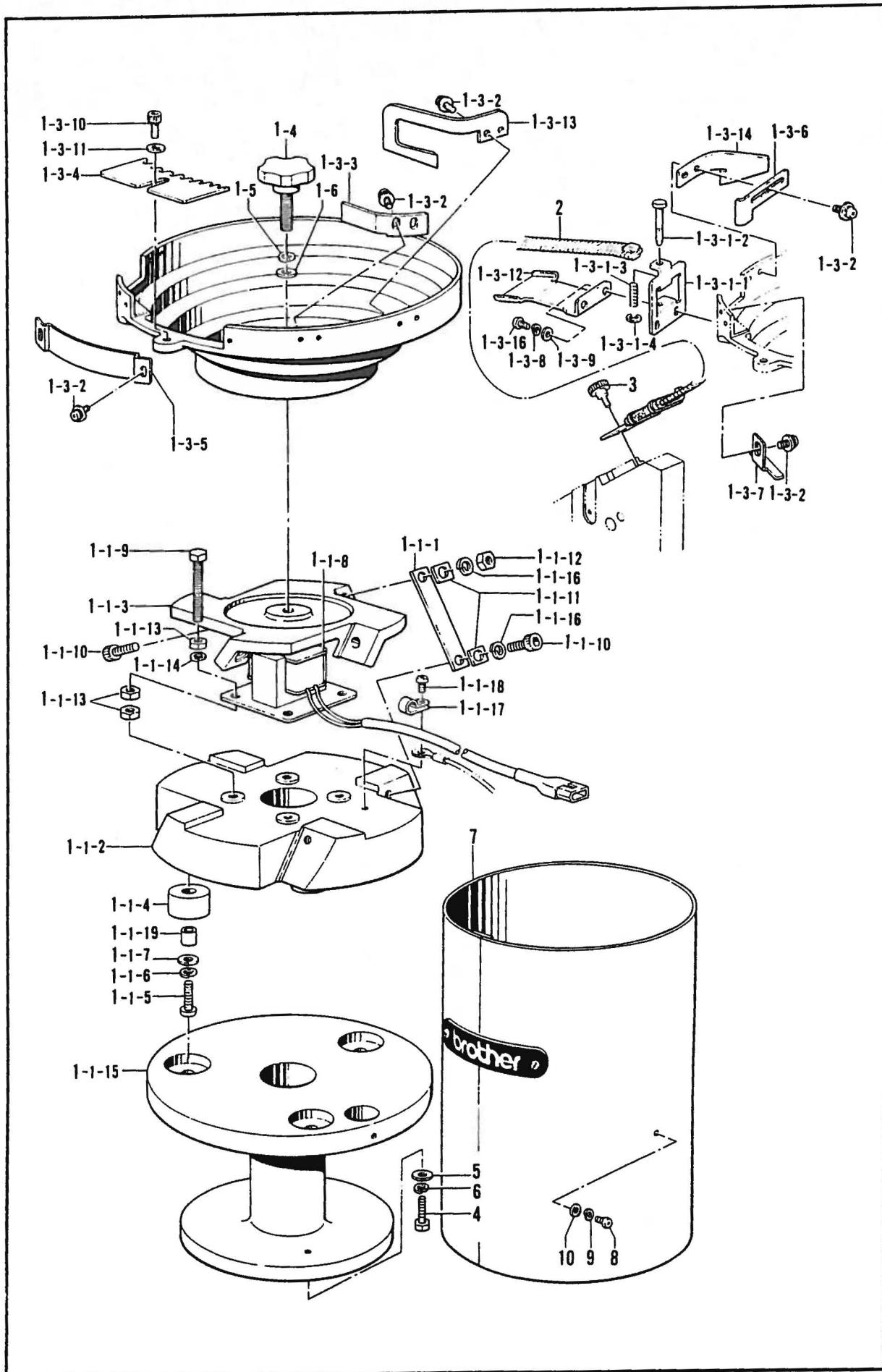
Q. フィーダー関係/Feeder mechanism/Knopfsortierer/Tricur de boutons/Mecanismo de botones
