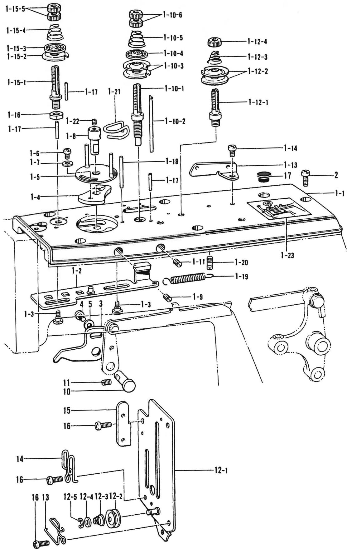
J. 糸通シ関係 / Threading mechanism / Fadenführungs vorrichtung /
