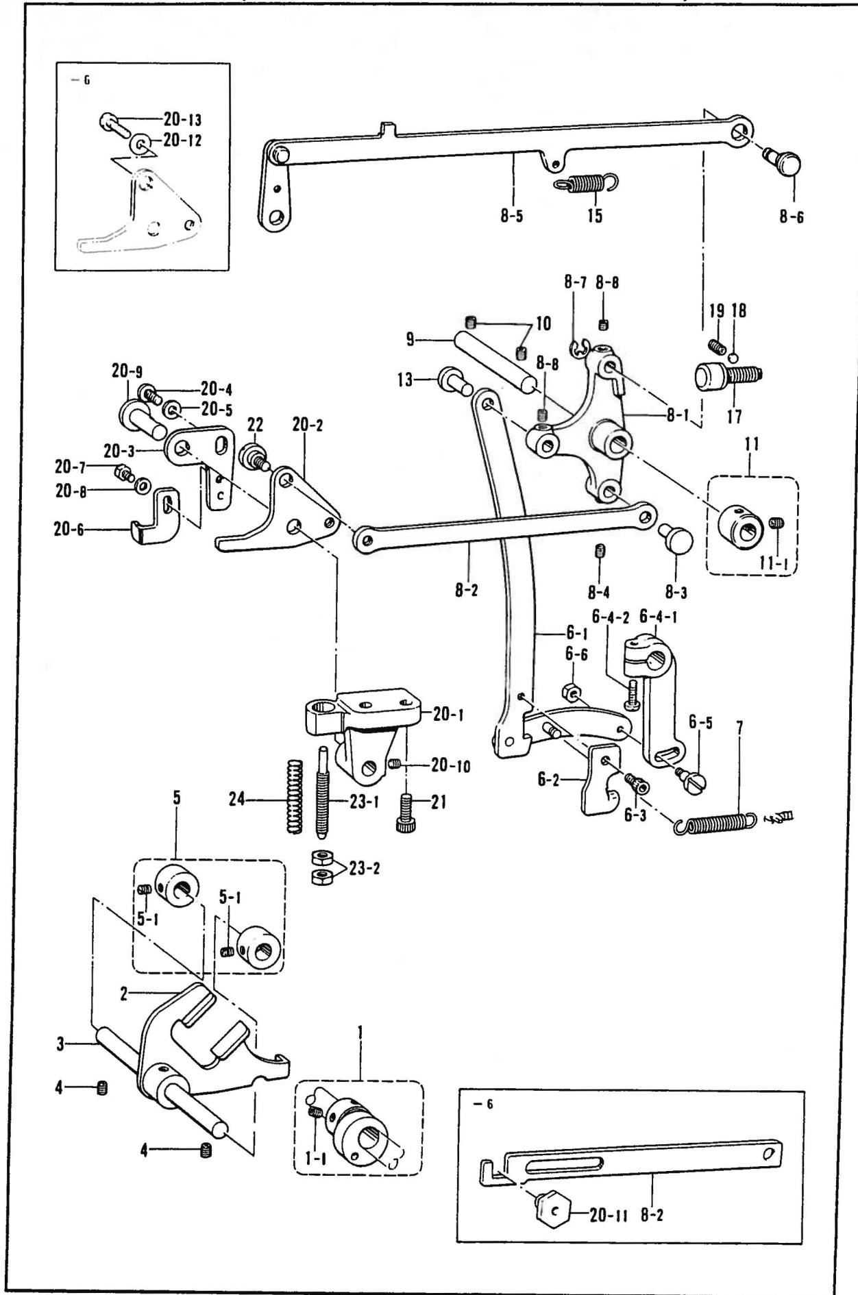
F. 押工上げ関係/Work clamp lifter mechanism/Stoffhalterhebervorrichtung/
