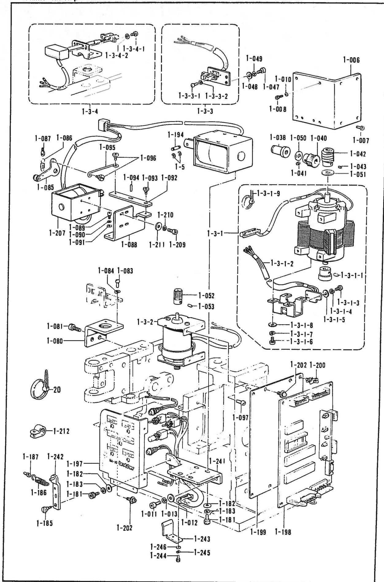
P2. ボタンフィーダー関係/Button feeder mechanism/Knopfzuführungsvorrichtung/
