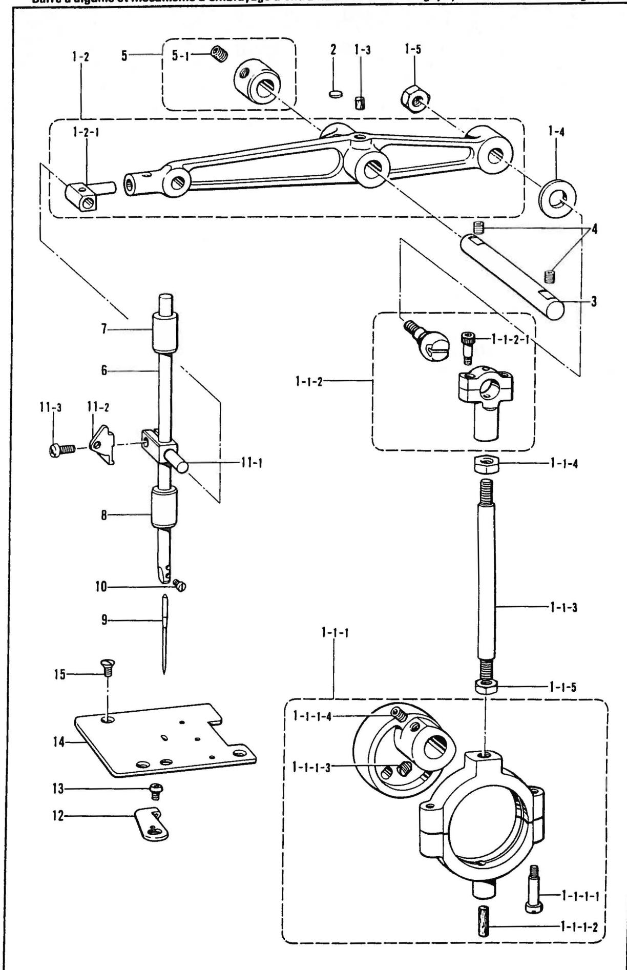
D. 針棒駆動関係 /Needle bar and driving clutch mechanism /Nadelstange und antriebskupplung /
