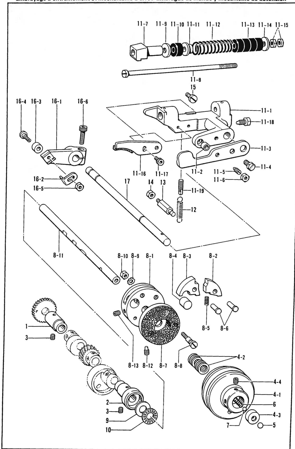
C. 駆動・停止関係/Driving clutch and brake mechanism/Antriebskupplung Und Stoppmechanismus/
