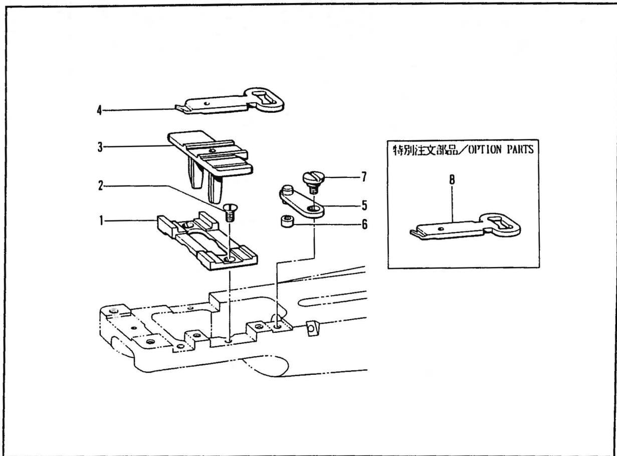
L. 糸拭イ関係/Tread wiper mechanism/Fadenwischvorrichtung/
