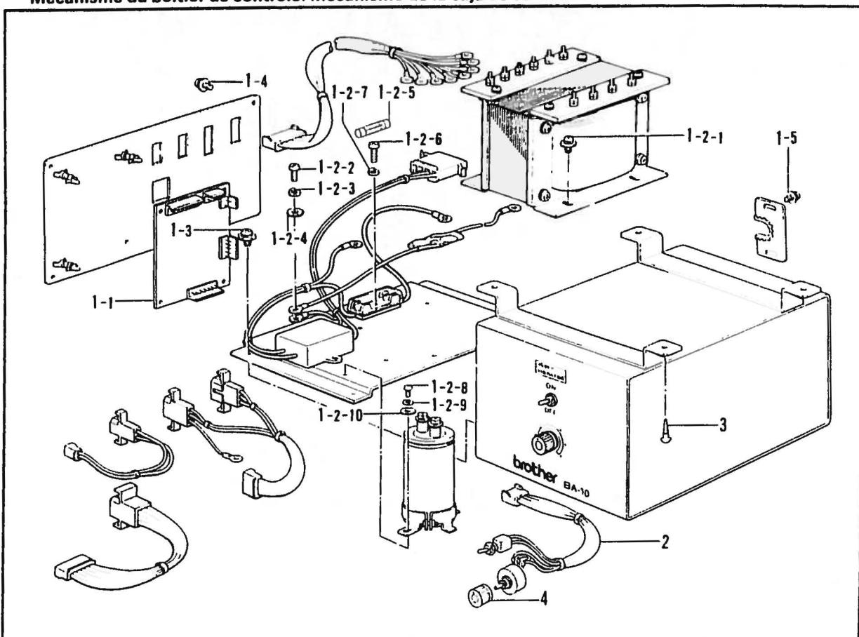
S. ボタン検知関係/Button detector mechanism/Knopfdetektor/Détecteur de bouton/Detector de botones
