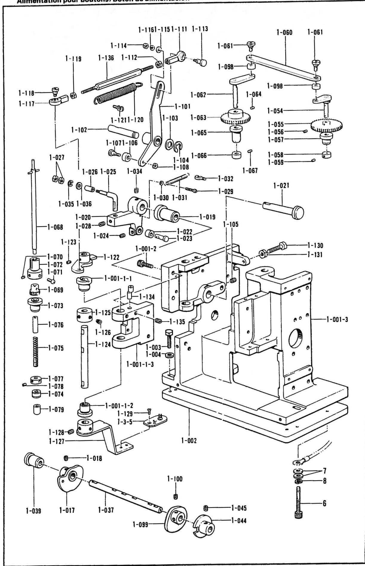
P1. ボタンフィーダー関係/Button feeder mechanism/Knopfzuführungs vorrichtung/
