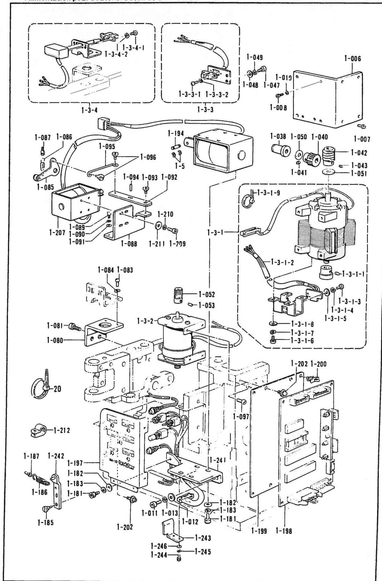
P2. ボタンフィーダー関係/Button feeder mechanism/Knoptzutuhrungvorrichtung/
