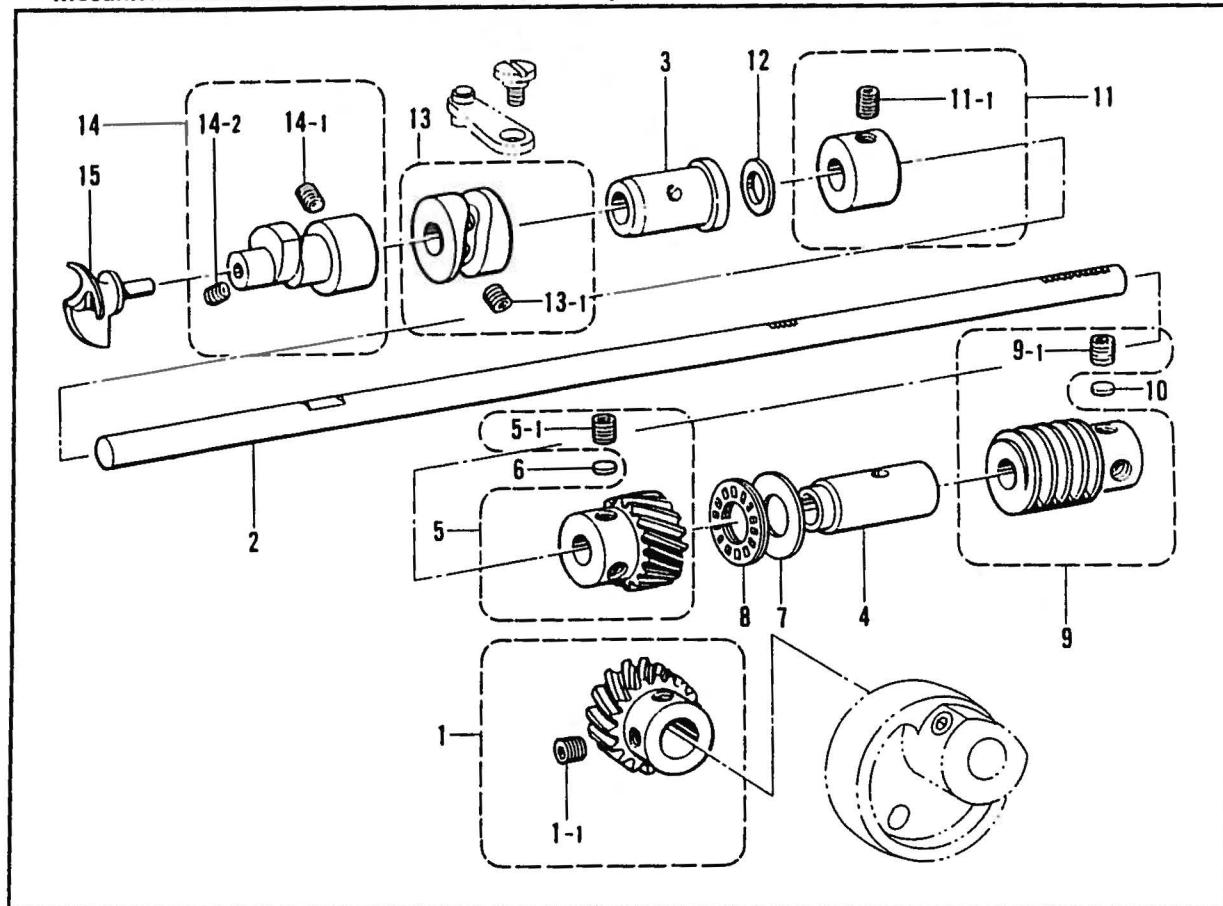
H. 糸切り関係/Thread trimmer mechanism/Fadenabschneidevorrichtung/
