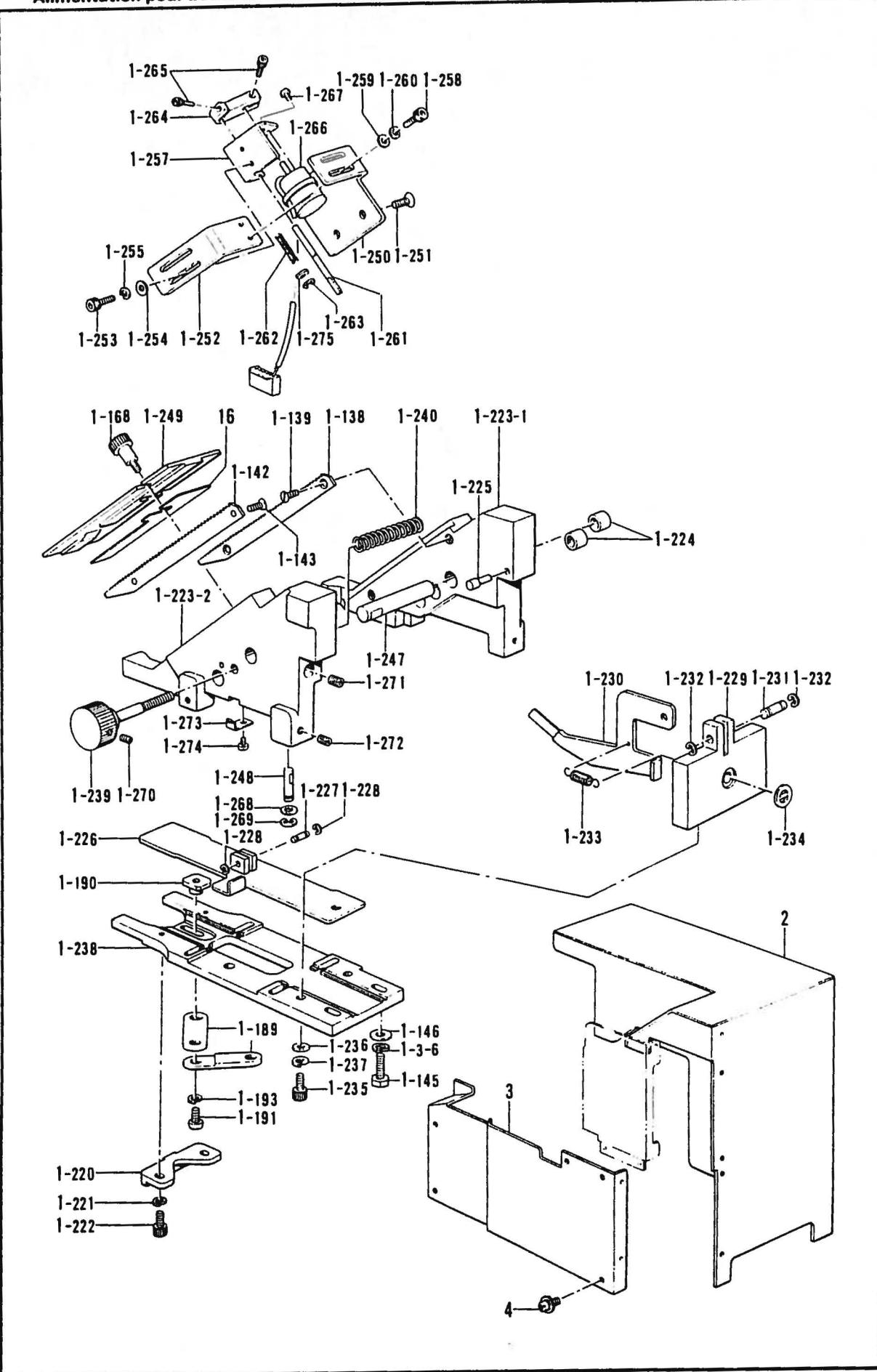
P3. ボタンフィーダー関係 / Button feeder mechanism / Knopfzuführungsvorrichtung /
