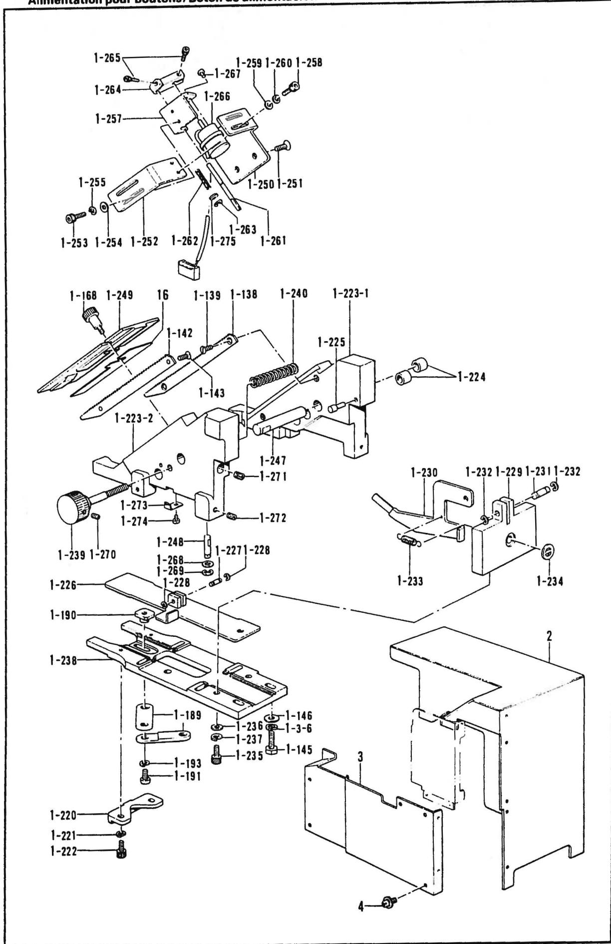
P3. ボタンフィーダー関係/Button feeder mechanism/Knopfzuführungvorrichtung/
