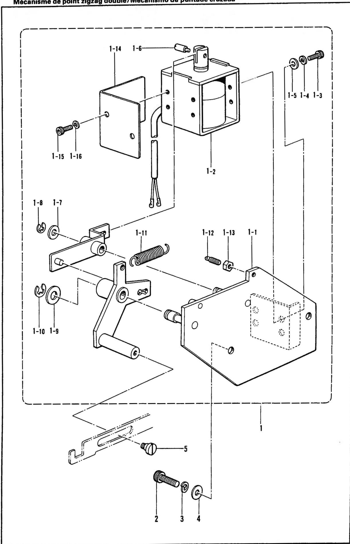
M. 通り糸関係/Crossover stitch mechanism/Verbindungsstichvorrichtung/
